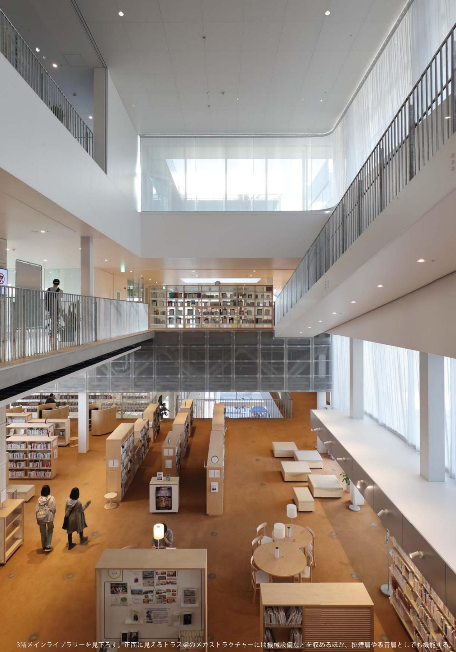
3階メインライブラリーを見下ろす。正面に見えるトラス梁のメガストラクチャーには機械設備などを収めるほか、排煙層や吸音層としても機能する。
