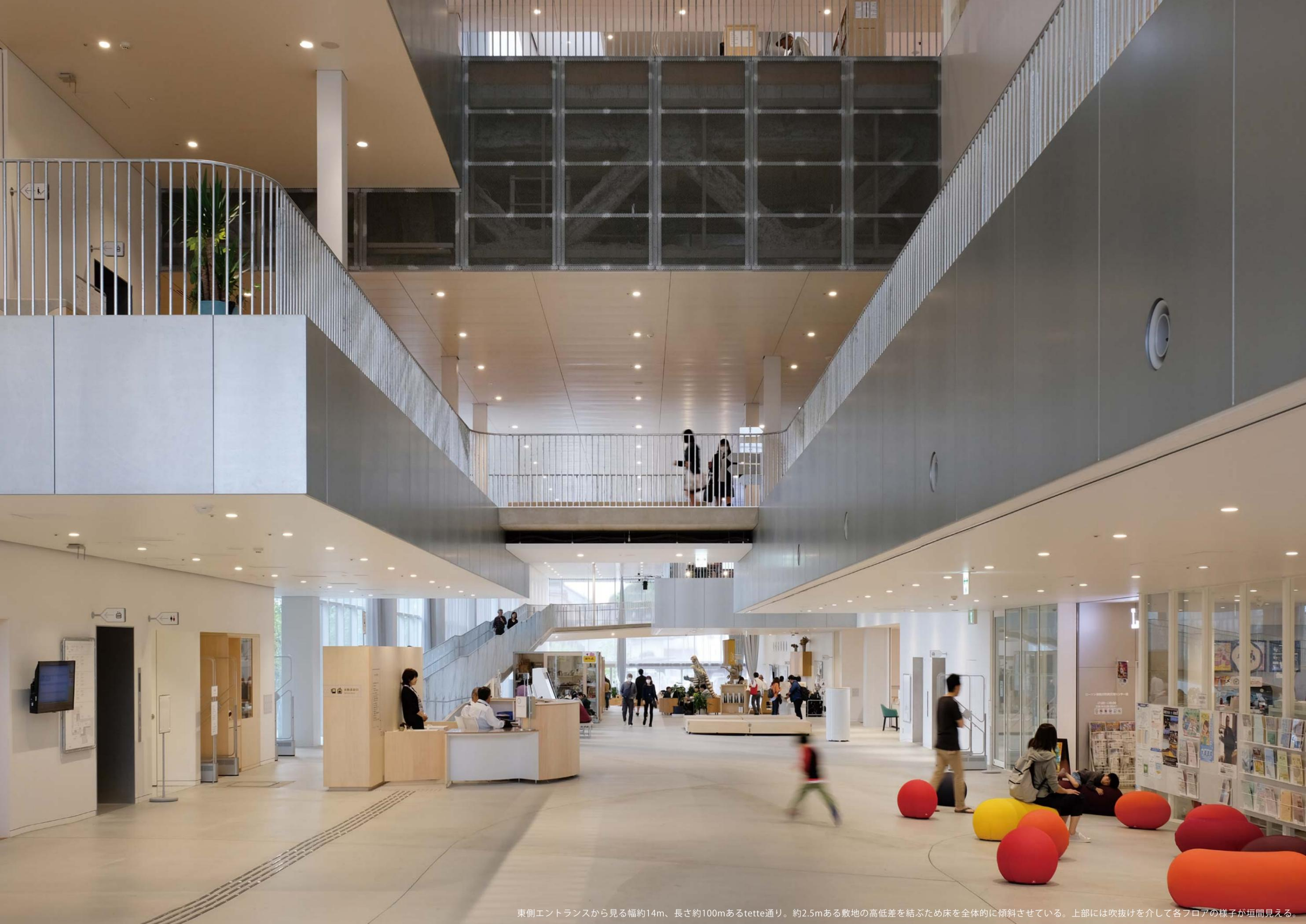
東側エントランスから見る幅約14m、長さ約100mあるtette通り。約2.5mある敷地の高低差を結ぶため床を全体的に傾斜させている。上部には吹抜けを介して各フロアの様子が垣間見える。
