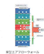
家型エアフローウォール 圧力損失 CFD 解析
